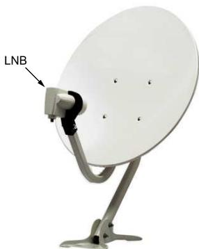
Le LNB (Low Noise Block convertter, convertisseur de bloc de faible bruit) permet de prendre une bande de fréquences relativement élevées, d'amplifier ces fréquences et de les convertir en signaux similaires transportés à une fréquence beaucoup plus faible, que l'on appelle fréquence intermédiaire (IF).
