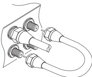
Quel que soit le type de raccordement entre le décodeur numérique et le téléviseur, vous devez relier le décodeur numérique à l'antenne de télévision afin de pouvoir recevoir les chaînes numériques.
