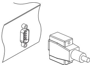
1. Branchez l'une des extrémités du câble RS-232 (câble D-sub à 9 broches) sur le port RS-232 de votre décodeur numérique et l'autre extrémité sur le port correspondant du second décodeur numérique.
