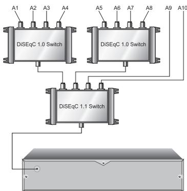
Par exemple, pour sélectionner l'antenne branchée sur l'entrée A5 dans l'illustration de gauche, paramétrez l'option DiSEqC 1.1 sur 2 de 4 et l'option DiSEqC 1.0 sur 1 de 4. Si vous avez un interrupteur DiSEqC 1.0 équipé de seulement deux entrées, paramétrez l'option DiSEqC 1.0 sur Mini A(2) au lieu de 1 de 4.
