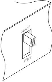
Si vous avez raccordé le décodeur numérique au téléviseur au moyen des connecteurs composant vidéo (Y, Pb et Pr) ou du connecteur HDMI, vous devez positionner le sélecteur de sortie vidéo de la face arrière sur YPbPr. Si vous avez raccordé le décodeur au téléviseur au moyen du connecteur péritel TV, vous devez positionner le sélecteur sur SCART. Les valeurs proposées pour l'option Video Format dépendront de la position du sélecteur.
