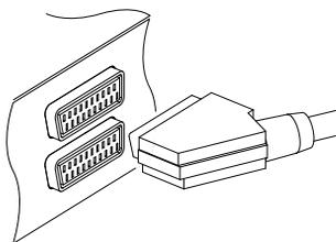
Pour obtenir un résultat optimal avec un téléviseur standard, utilisez un câble péritel. Branchez une extrémité du câble à la prise TV du décodeur numérique et l'autre extrémité à une prise péritel de votre téléviseur.
