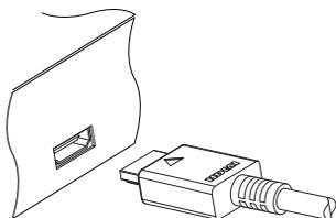
Si vous possédez un téléviseur haute définition, utilisez un câble HDMI pour obtenir un résultat optimal. Branchez une extrémité du câble à la prise HDMI du décodeur numérique et l'autre extrémité à la prise correspondante de votre téléviseur. Vous n'avez pas besoin d'effectuer de raccordement audio : le connecteur HDMI assure une sortie audio stéréo ou Dolby Digital.
