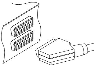
Pour utiliser le connecteur péritel auxiliaire, vous devez vous procurer un câble péritel. Branchez une extrémité du câble à la prise VCR du décodeur numérique et l'autre extrémité à la prise correspondante de votre magnétoscope (ou de tout autre appareil semblable).
